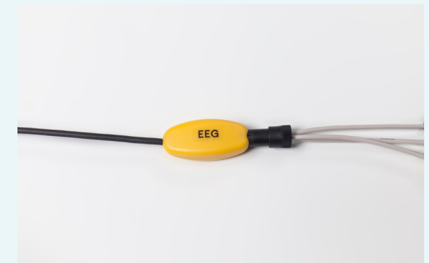
Ein EEG-Sensor misst die Gehirnwellen des Kindes und stellt sie am Bildschirm dar.
